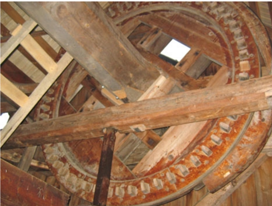
Hinkabölen tuulimyllyn 2. kerroksen ratashuoneen hammasratas ja hammasrattaan pyöritysakseli, kuvaus 2006-11-18 (PHo)
