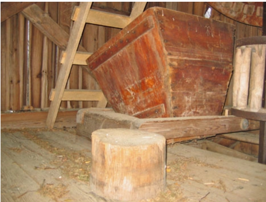
Hinkabölen tuulimyllyn 2. kerroksen ratashuoneen navan pää sekä jyvökaukalo, kuvaus 2006-11-18 (PHo)
